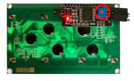
Die Helligkeit kann mit einem Potentiometer auf der Rückseite des LCDs eingestellt werden.
