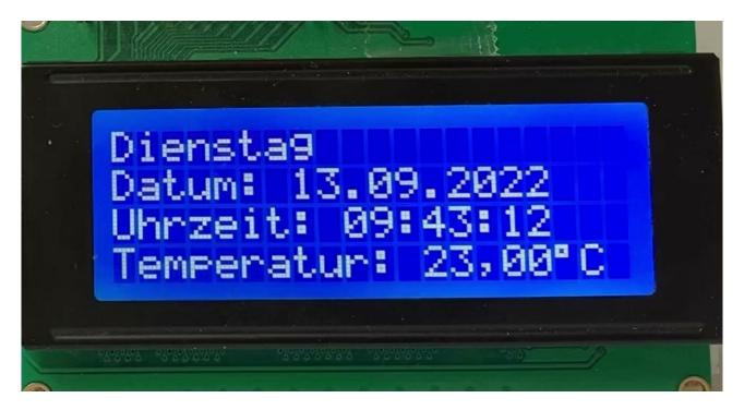
Normalerweise wäre eine komplexe Verkabelung zum Betrieb eines LCDs nötig. Der I2C-Bus regelt über einen eigenen Mikroprozessor die Kommunikation der Datenleitungen untereinander. Es werden deshalb nur vier Anschlüsse benötigt.
