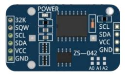
Der Arduino kann nur ab dem Zeitpunkt des Einschaltens die Zeit messen. Das aktuelle Datum und die Zeit kann nur mit einem RTC-Modul (RealTimeClock) gesetzt und gelesen werden.
