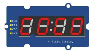
Die 7-Segment-Anzeige besteht aus 4 Zeichen. Jedes dieser Zeichen besteht aus 7 sogenannten Segmenten, die einzeln angesteuert werden können. Die Anschlüsse:
