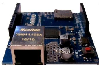
Für diese Anleitung benötigst du ein sogenanntes „Shield“, eine Platine, die einfach auf den Arduino aufgesteckt wird. Auf ihr befindet sich ein LAN-Anschluss (RJ45). Alle digitalen und analogen Anschlüsse stehen auch weiterhin zur Verfügung.
