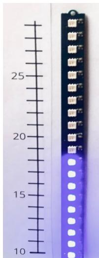
Ein DHT11, ein DHT22 oder ein BMP280 misst die Temperatur und zeigt sie in Schritten zu je ein Grad auf einem Neopixel-Stick an. Die gemessene Temperatur wird auf ganzzahlige Werte gerundet.
