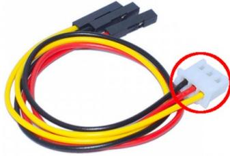
Der Temperatursensor LM35 ist ein analoger Sensor. Er misst die Spannung am analogen Eingang des Arduinos und wandelt sie durch eine Rechnung in die Temperatur um. Der im Bild gezeigte wird mit einem JST XH2.54 mm – 3P-Stecker mit dem Arduino verbunden.
