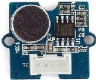
Nimmt der Soundsensor ein Geräusch wahr, wird die LED eingeschaltet. Bei einem weiteren Geräusch schaltet sie sich wieder aus. Leider wird das Signal nicht verstärkt, deshalb reagiert der Soundsensor am ehesten auf vorsichtiges Klopfen auf das Mikrofon oder auf Pusten gegen das Mikrofon.
