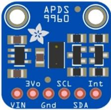
Der APDS-9960 analysiert mit Hilfe einer Infrarot-LED Bewegungen in seinem Sichtbereich. Dabei kann er vier Richtungen (links, rechts, nach vorn, nach hinten) unterscheiden, die Handbewegungen vom Sensor weg und zum Sensor hin erkennen und die Farben Rot, Grün und Blau „sehen“. Er wird über I<sup>2</sup>C angesteuert.
