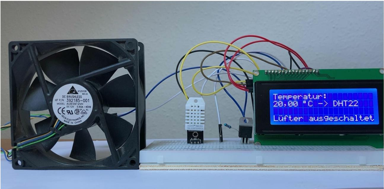
Der hier verwendete Lüfter stammt aus einem ausrangierten Computer. Er hat 12 V und eine Leistungsaufnahme von  $0,6 \text{ A} = 600 \text{ mA}$ .
