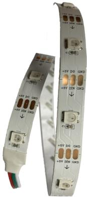
Der LED-Streifen besteht aus mehreren miteinander verbundenen RGB-LEDs. Jede besitzt einen eigenen Controller und kann einzeln angesteuert werden. Er benötigt nur einen digitalen Eingang. LED-Streifen gibt es in verschiedenen Längen.
